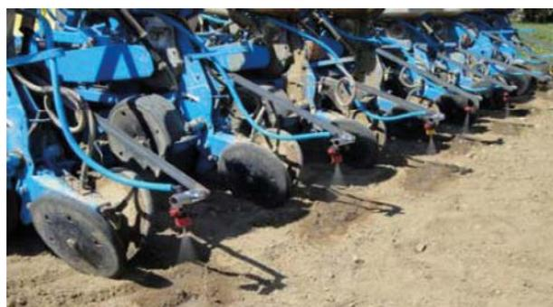
kit de pulvérisation sur le rang monté sur semoir
