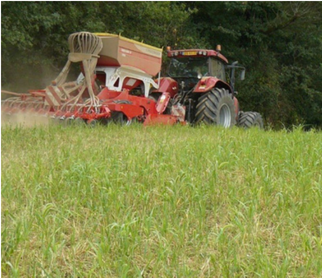
Figure 5 Semis direct d'une prairie à flore variée dans un Moha-Trèfle d'Alexandrie avec un semoir à disque Pottinger Terrasem.
